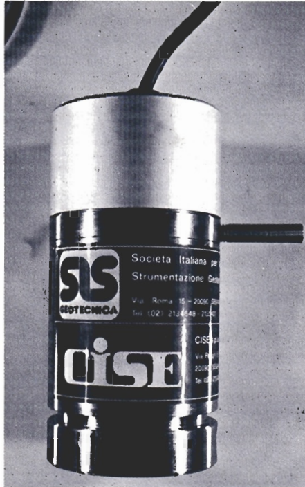
Componente del misuratore automatico di livelli e di inclinazioni sviluppato congiuntamente dal CISE e dalla SIS Geotecnica. A destra, disegno della sezione del componente. Legenda: 1, Aria. 2, Circuito elettronico. 3, Trasduttore. 4, Liquido speciale.
