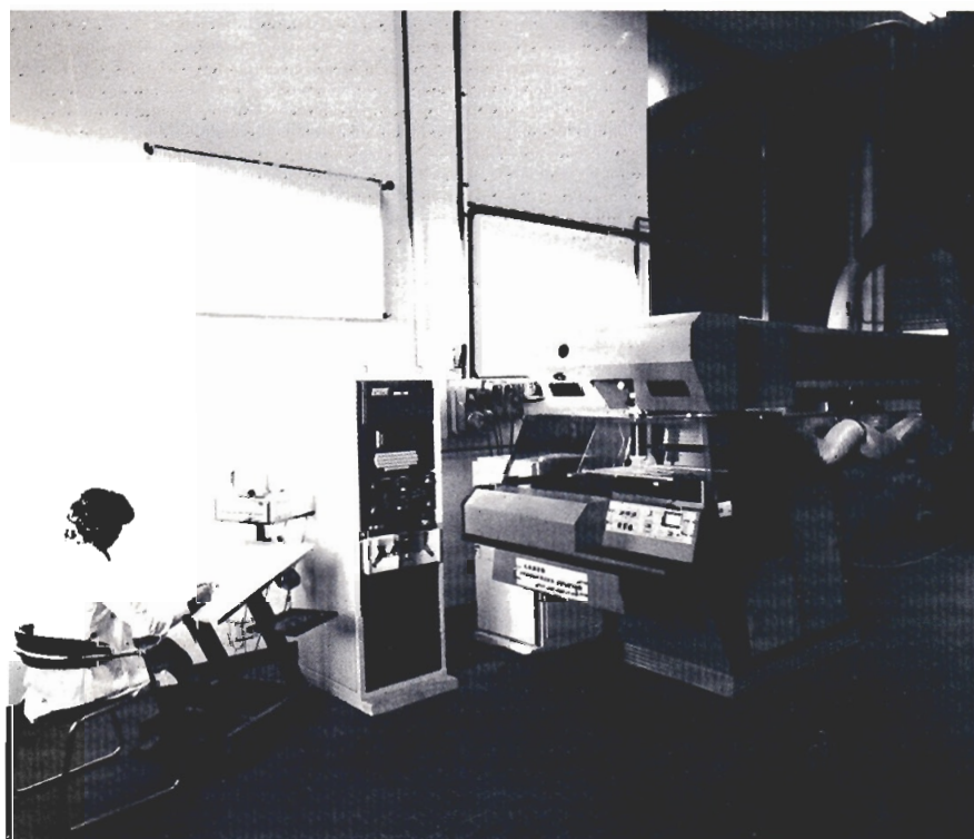
◀ Il sistema laser Valvivre a CO 2 , da 500 W, di cui è dotato il Centro Applicazioni Laser del CISE.
